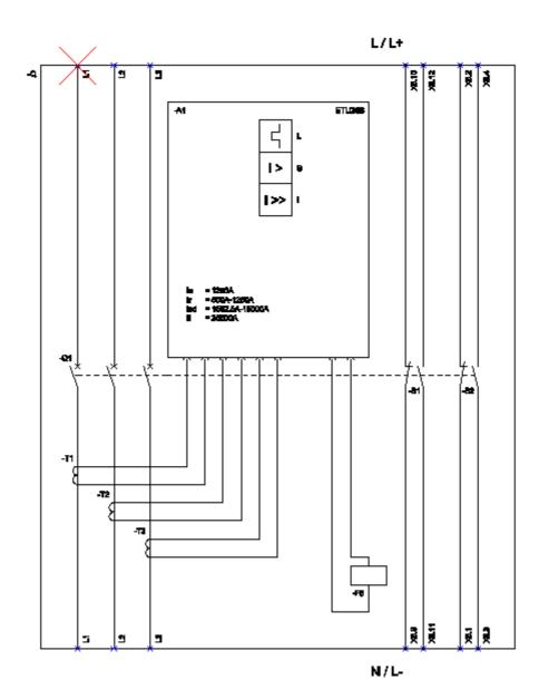
L (Long Time Delay / Oberlastschuts); S (Moort Time Delay / Enrachlussschuts, burschiversögert); I (Instantanaous / Enrachlussachuts, uncersögert); FS (Englatch for trip unit / Amaléssanguet); 81 - 88 (Auxiliary switch / Hilfsechalter);
